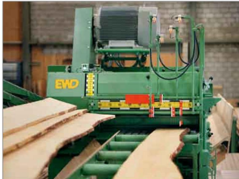
Die handbeschickte Besäum- und Nachschnittkreissäge DK 90 ist die perfekte Ergänzung zu den Hauptmaschinen wie Gatter oder Blockbandsäge im kleinen und mittleren Sägewerk. In größeren Betrieben wird die DK 90 als wertvolle Nebenmaschine für vielseitige und flexible Aufgabenstellungen eingesetzt.
