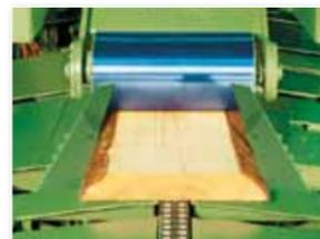
Positionierung durch Zentrierzangen
