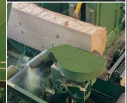
Blockbandsäge EBB 1800 für Vor- und Rückwärtsschnitt, Profilspaneraggregat PF 19 und Blockbandsägewagen EW 1000
