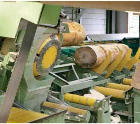
Kein anderes Einschnittverfahren bietet so viele flexible und individuelle Möglichkeiten Rundholz in verschiedene Produkte aufzuteilen, wie die Blockbandsägetechnik.
