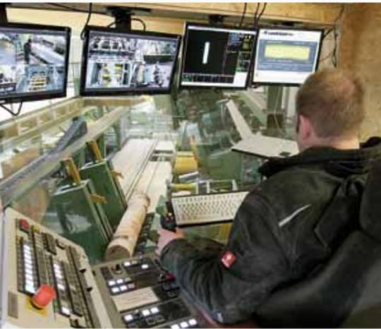
Die Neigung von Blockbandsägewagen und Bandsägenständer um 17° setzt sich unaufhaltsam durch.
